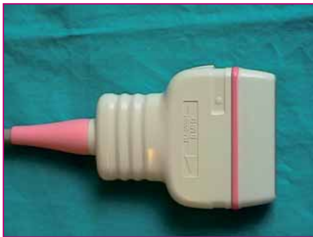
Fig. 78.2. Sonda lineare da 8 MHz per esami di strutture superficiali. Questa sonda può essere corredata di dispositivo laterale di guida per ago.
