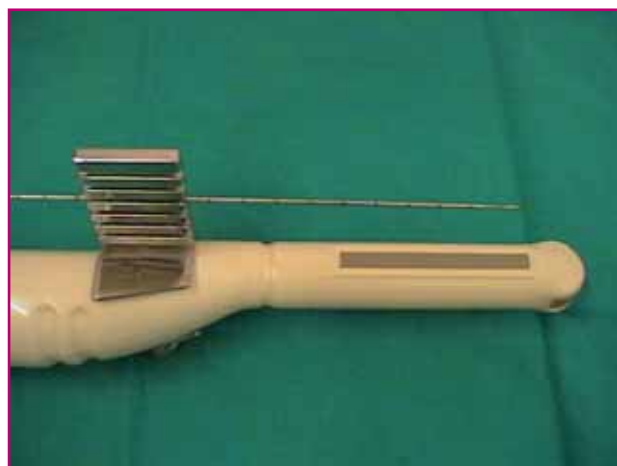
Fig. 78.3 a-e. (a) Sonda endocavitaria di tipo transvaginale, monoplanare, microconvex, da 7,5 MHz. (b) Sonda endocavitaria per insonazione transrettale biplanare, microconvex e lineare. (c) Sonda endorettale lineare con dispositivo di guida che permetterà all'ago di decorrere parallelamente al piano di emissione degli US. (d) Dispositivo di guida di sonda microconvex endocavitaria transrettale; si noti la lieve inclinazione predefinita e non variabile di detto dispositivo. (e) Dispositivo di guida di sonda microconvex endocavitaria transvaginale; si noti la lieve inclinazione predefinita e non variabile di detto dispositivo.
